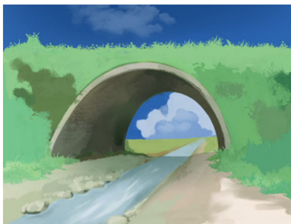
Rys. 87. Przepust/most z naturalnym dnem [Przybyła 2002, zmieniony]
